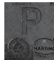
Datumsuhr in einem P-Modul
